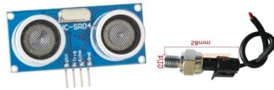
Gambar 4 Sensor HC-SR04[3] dan Sensor Tekanan[4]
