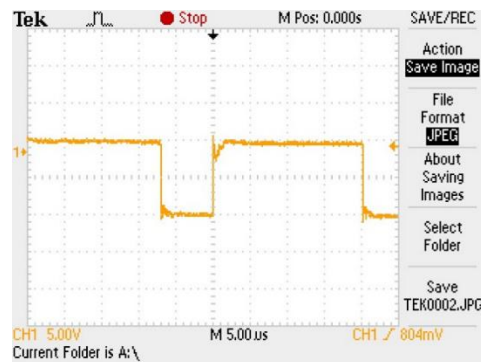
Gambar 17. Gelombang Pulsa Dari Keluaran Rangkaian Pembangkit Pulsa (Osilator)
