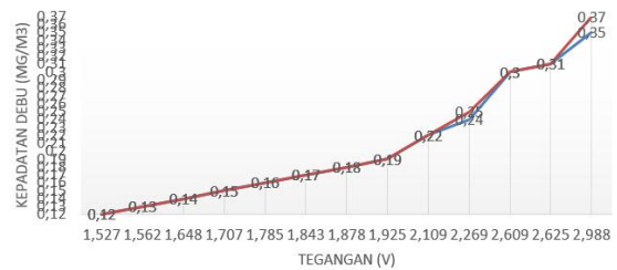
Gambar 13.Grafik Pengujian Sensor Debu Sharp GP2Y1010AU0F
