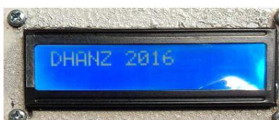
Gambar 4.1. Pengujian LCD 16x2
