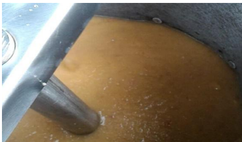
Gambar 4.9. Campuran Crushed Apple dengan Air Minum disalurkan menuju Spinner
