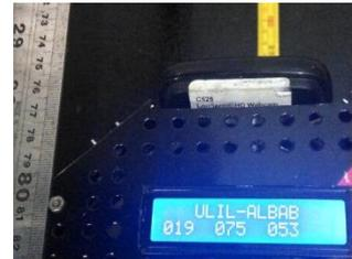
Gambar 4.3 Pengujian SRF08 jarak 75cm
