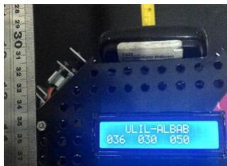
Gambar 4.1 Pengujian SRF08 jarak 30cm
