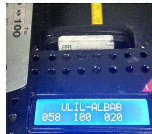
Gambar 4.4 Pengujian SRF08 jarak 100cm
