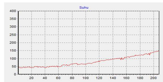
Gambar 4.2 Grafik Respon Terhadap Sudut Target Sebesar 150°C dengan nilai tuning PID K_p=10.3, K_i=0.045, K_d=587.1
