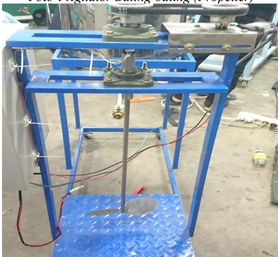
Foto 2 Penempatan Posisi Agitator Baling-baling (Propeller)
