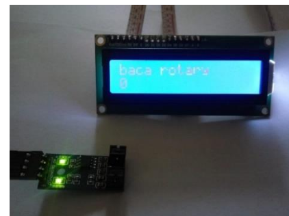
Gambar 15 Pengujian Sensor Rotary Saat Optokopler tidak Terhalang
