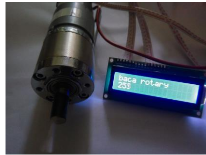
Gambar 19 Data Pengujian Rotary Encoder dengan Searah Jarum Jam
