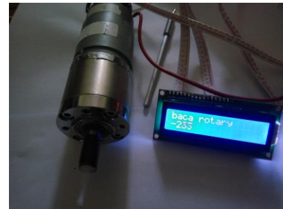
Gambar 20 Data Pengujian Rotary Encoder dengan Berlawanan Arah Jarum Jam
