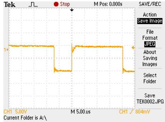
**Gambar 9** Gelombang Pulsa Hasil Pengujian Rangkaian Driver Flyback
