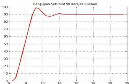
Gambar 20 Pengujian dengan 3 Beban (150 gram)
