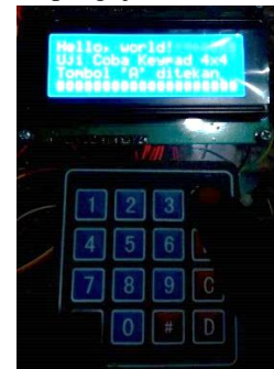
Gambar 13 Hasil Pengujian LCD 4x20 dan keypad
