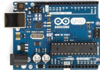
Gambar 1. Bentuk fisik Arduino Uno
