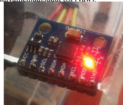
Gambar 2. Bentuk fisik sensor Accelerometer MPU6050
